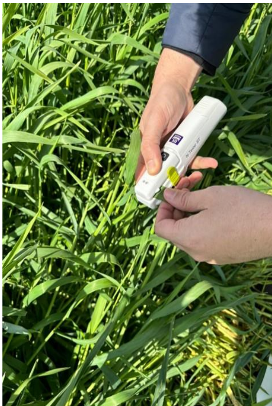
Рис. 1. Визначення потреби в мінеральному азоті за допомогою приладу Yara N-Tester для проведення підживлення озимої пшениці
